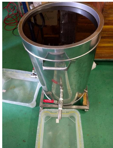
Bild 13: Nach dem Reinigungs- und Desinfektionsvorgang ist das Wachs zur Ruhe gekommen und kann nun auf ca. 80°C abkühlen.
