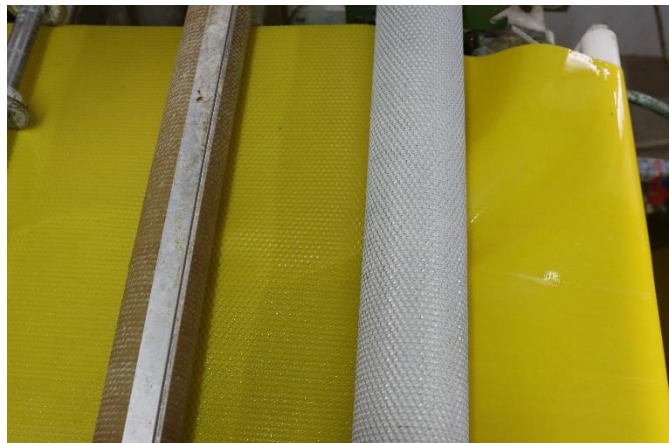
Bild 19: Prägewalzen pressen die Wabenstruktur in das Wachsband.
