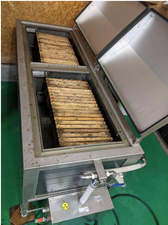
Bild 8: Altwaben werden im Dampfwachsschmelzer ausgeschmolzen.
