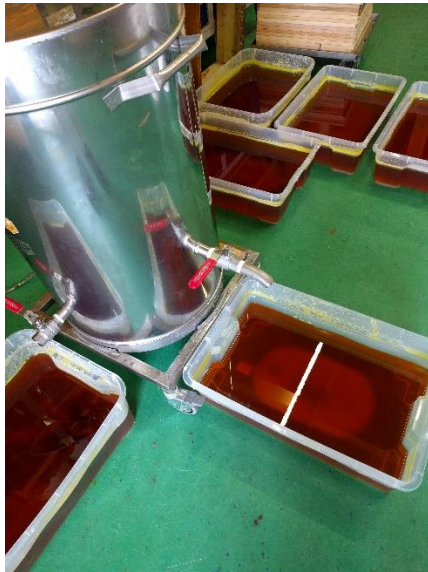
Bild 15 (links): Das reine Bienenwachs wird über den rechten Ablasshahn in flache Wannen gegossen. Zuletzt wird restliche Wachs in eine separate Wanne abgelassen (links), bei dem etwas Trub dabei sein kann.
