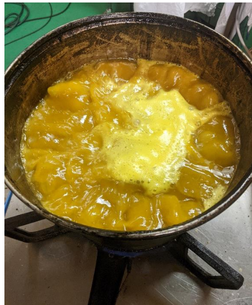
Bild 12: Die Rohwachsblöcke werden zur ersten Reinigung mit Wasser aufgeköcht.
