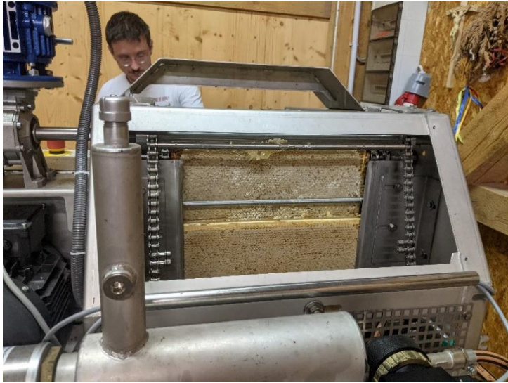
Bild 10: Beim maschinellen Entdeckeln der Honigwaben fällt viel Entdeckelungswachs an.
