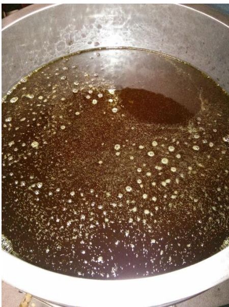
Bild 14: Im Wachsklärbehälter erfolgt der letzte Reinigungsschritt. Auch das im Bienenwachs enthaltene Restwasser kann verdampfen. Hier gut zu sehen an den aufsteigenden Bläschen.
