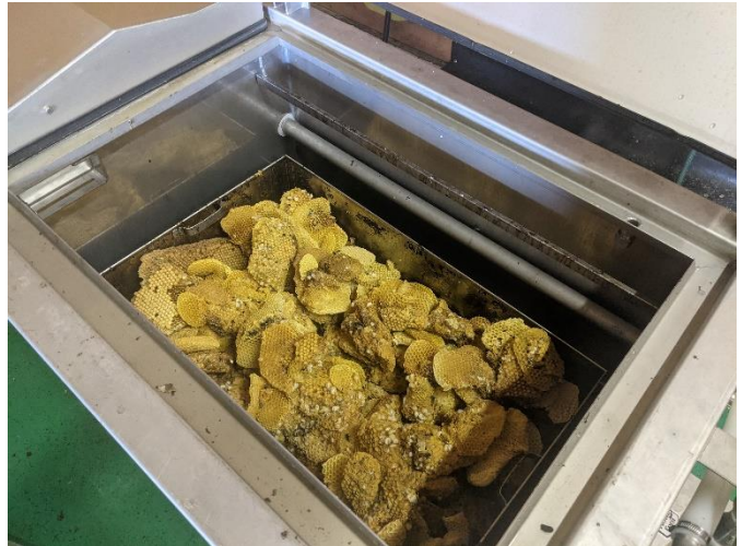
Bild 9: Der Dampfwachsschmelzer eignet sich hervorragend für Drohnen- und Wildbau. Dieser wird in einer speziellen Wanne ausgeschmolzen.
