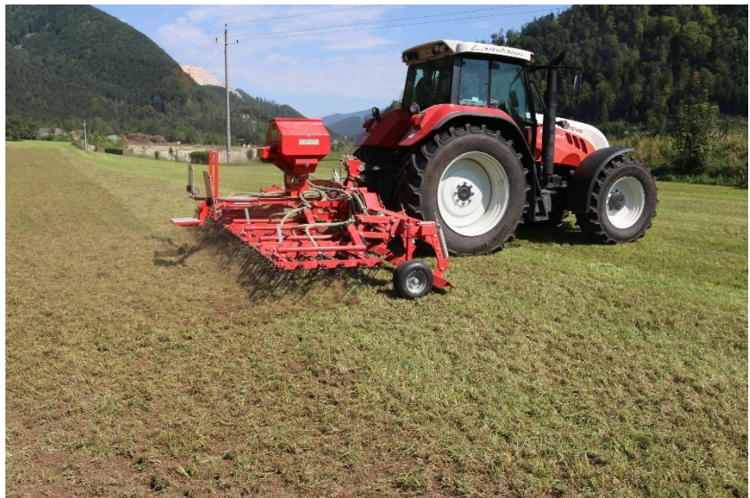
Bild 9: Sanierung Nachsaat mit PneumaticStar Pro; 13. August 2018
