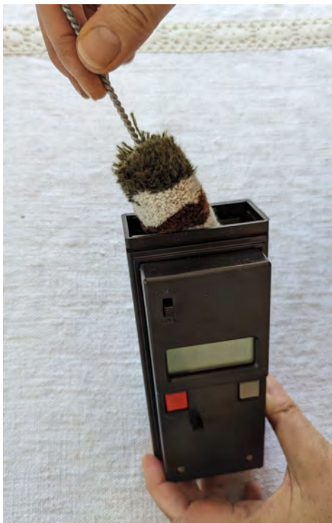
Bild 43: Mit der Reinigungsbürste aus Wolle lässt sich der Pollenstaub sehr gut aus der Messkammer entfernen.
