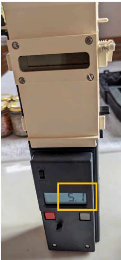
Bild 42: Nach Öffnen der Fallklappen fällt der Pollen nach unten in die Messkammer. Der Feuchtegehalt wird sofort am Display angezeigt. Ist die Umgebungstemperatur anders als 20°C muss der angezeigte Wert korrigiert werden.
