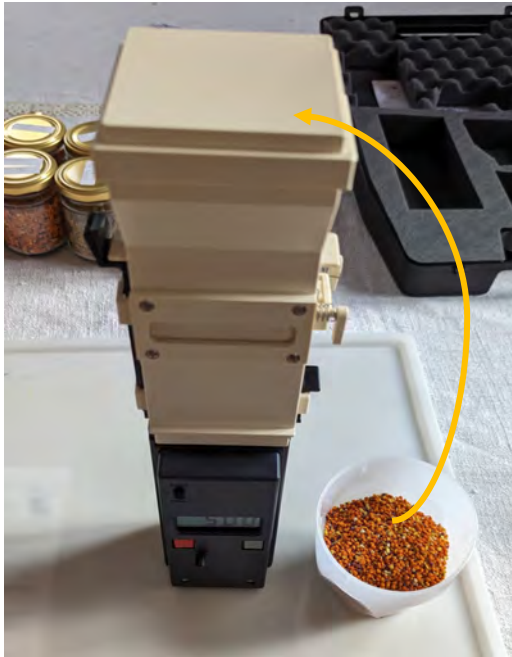
Bild 41: Das Messgerät H40 zusammengestellt. Der Pollen wird zur Messung in den nach unten geschlossenen Füllraum unter dem Deckel geschüttet.
